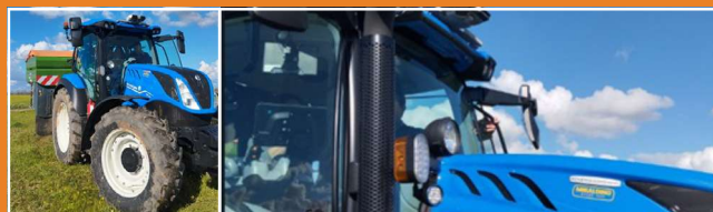
Figura 1. Trator New Holland T5.140 dynamic command, com distribuidor de adubo Amazone ZA - TS 4200 acoplado e sensor On-The-Go no topo da cabine
