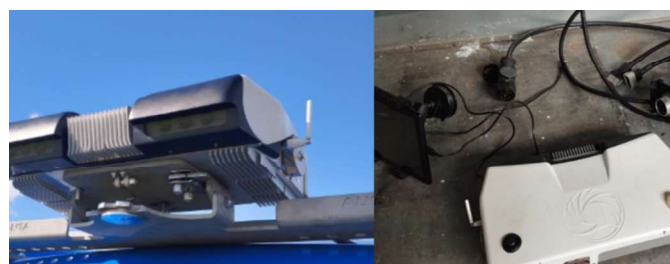
Figura 2. Sensor On-The-Go (à esquerda) e controlador, cabos de ligação à linha ISOBus, e detalhe da parte superior do sensor, onde se localizam os sensores de radiação (à direita)
