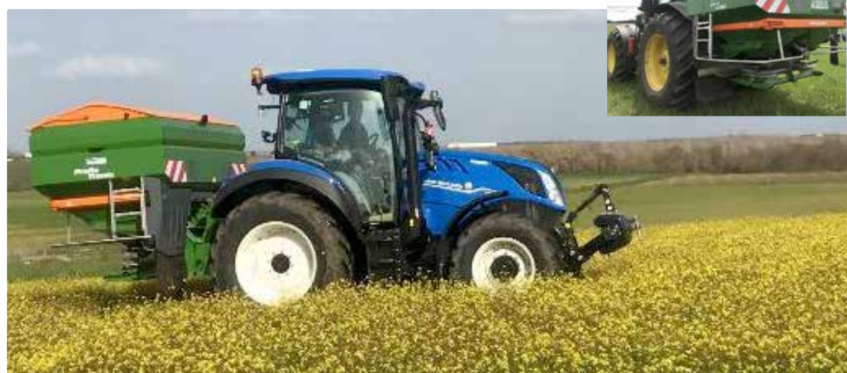
Figura 1. Conjuntos mecanizados, tratores New Holland T5 120 e John Deere 7260 R, e distribuidor de adubo centrifugo montado de discos Amazone ZAV-4200.
