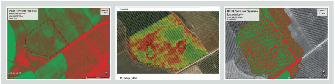
FIGURA 1. Sequência de 3 imagens da mesma parcela de olival com diferentes resoluções espaciais, obtidas a partir de imagens de Satélite sem processamento (à esquerda), de Satélite com processamento (Plataforma Agromap, https://agroinsider.com/ ) (ao centro) e a partir de voo de baixa altitude com drone (à direita).
