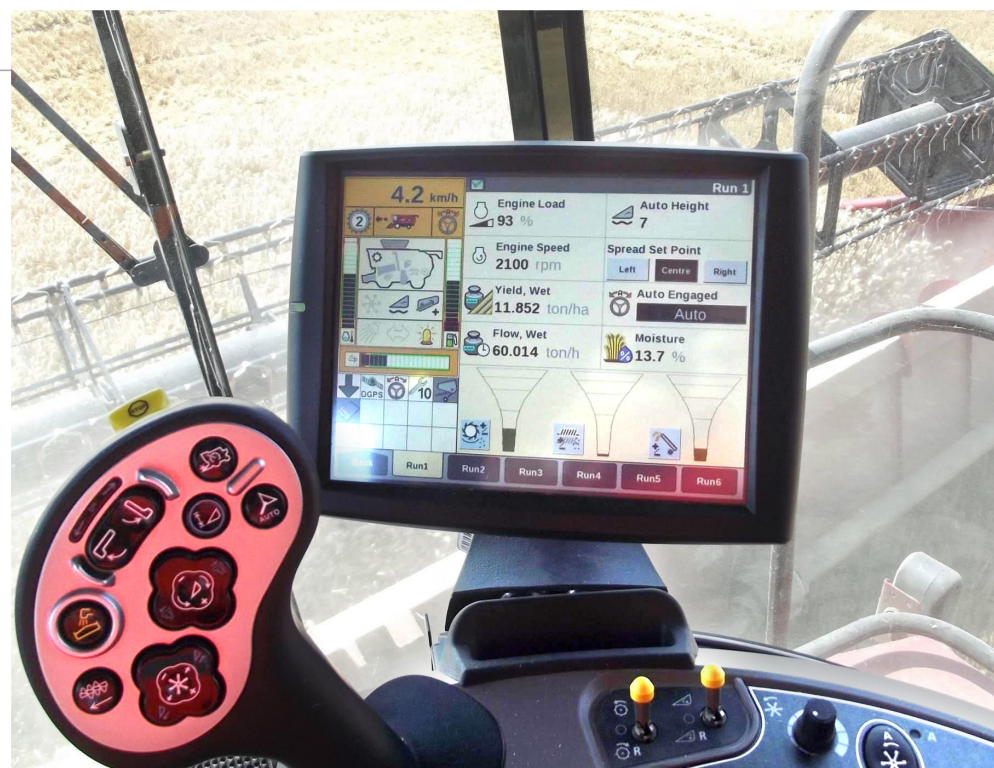
Figura 4. Monitor de rendimento AFS 700 de uma ceifeira da marca Case com dados de colheita de trigo obtidos em França na região de Chartres.
