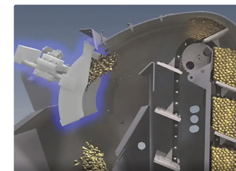
Figura 2. Esquema de localização do sensor de impacto de massa (a cinzento no canto superior esquerdo da figura) montado no topo do elevador de grãos de uma ceifeira debulhadora New Holland ( https://agriculture.newholland.com/eu/pt ).
