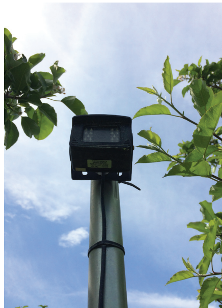
FIGURA 9. Sistema remoto de monitorização fenológica.
