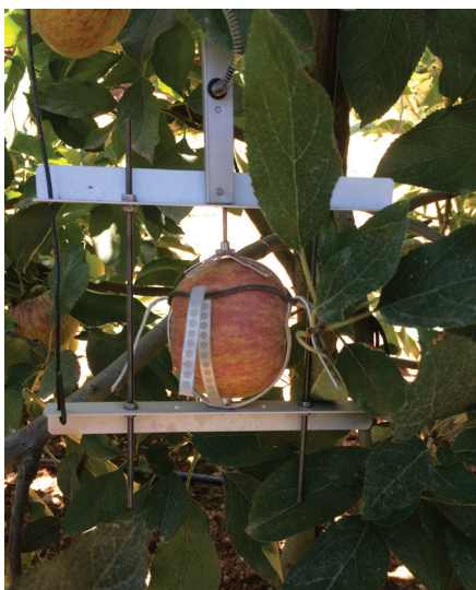
FIGURA 8. Dendrômetros de tronco e fruto para controlo remoto de crescimentos, gestão de rega e aplicação em modelos de previsão de calibres e produções.
