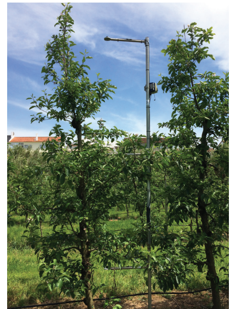
FIGURA 10. Sistema de monitorização da distribuição de radiação no coberto vegetal.
