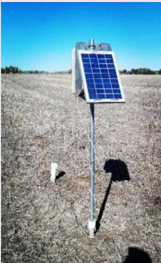
Figura 2 - Sonda e layout Usens (Terra Pro) da evolução do teor de água no solo a 10 e a 20 cm de profundidade, entre o dia 1 de janeiro e o dia 1 de março de 2021 na Herdade da Comenda medido a partir de dois sensores EnviroSCAN® no projeto ISOMap Forragem. Os dados são enviados via GPRS cada 2 horas, sendo a sonda e unidade de comunicação alimentadas por um painel solar. As leituras dos sensores são feitas com uma frequência de 15 minutos.
